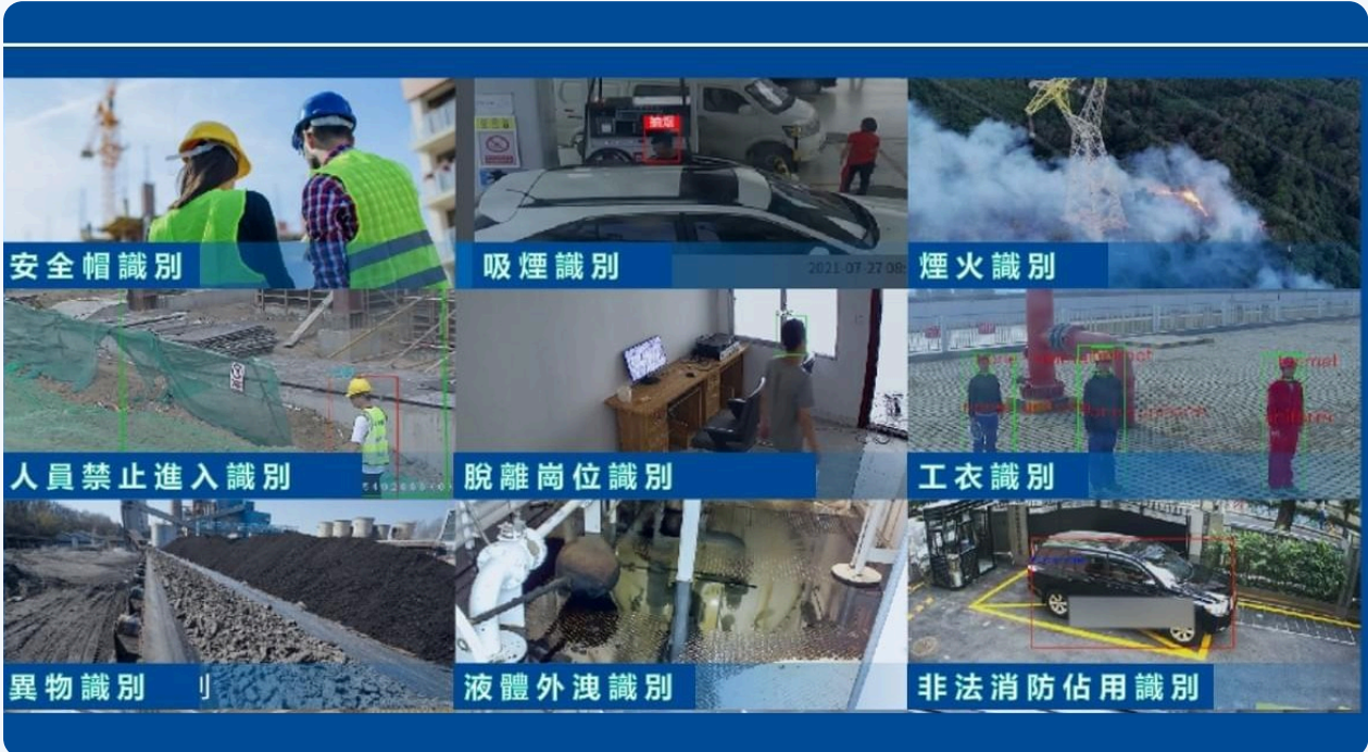
AI 影像分析實際偵測示例 —— 安全帽·吸煙·煙火·禁區闖入·脫崗·工衣·異物·液體外洩·非法消防佔用
